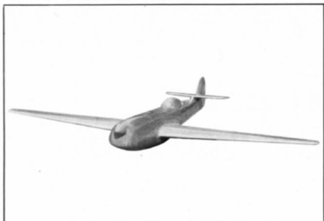
21. Il modellino da galleria del BN.2, il piccolo caccia saettato derivato dal BN.1. Ala e fusoliera furono sottoposte alle prove statiche ma il programma non ebbe seguito. (foto via Bruno Terrevoli).
